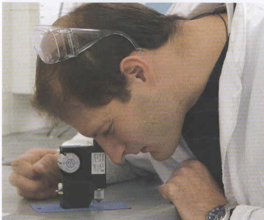
7- Una prova di valutazione dello spessore dei vari strati del ciclo di verniciatura con il PIG (Paint Inspector Gauge).
