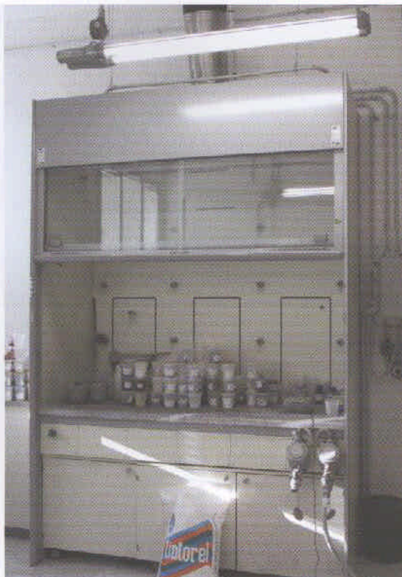
2- Il tavolo di lavoro è dotato di cappa aspirante, le lampade e i macchinari adiacenti sono conformi alla normativa ATEX.
